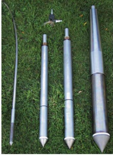
Şekil 2.6. 2, 10, 15 ve 40 cm 2 izdüşüm alanına sahip konik sondalar (Robertson ve Cabal, 2010)
